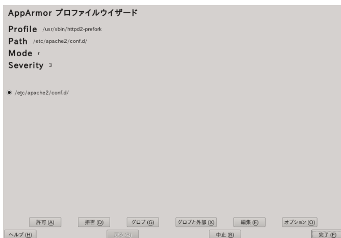
図 21.3 学習モードの例外: 項目に対する実行許可の設定
