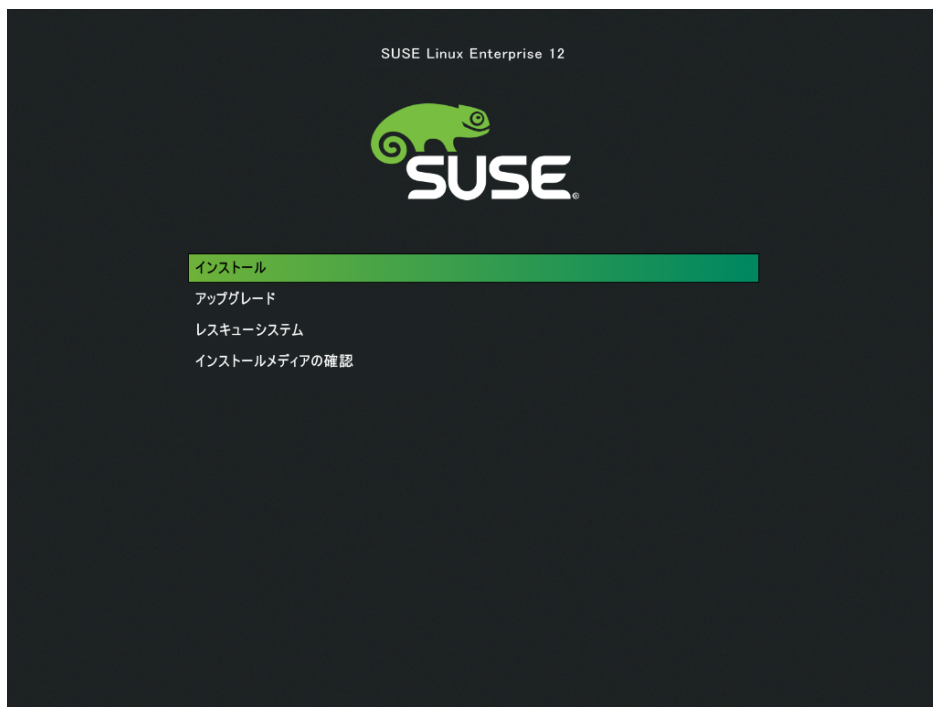
図 6.2 UEFIを使用したマシンのブート画面
