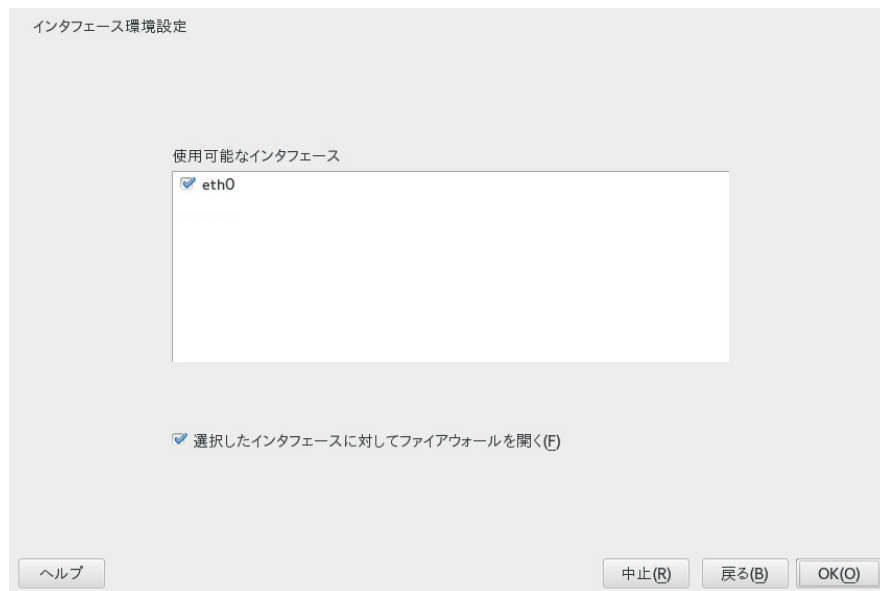
図 24.11 DHCPサーバ:ネットワークインタフェースとファイアウォール
