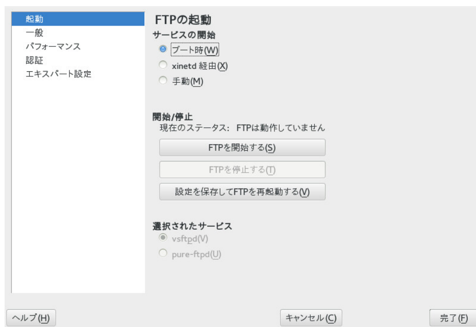
図 30.1 FTPサーバの設定 — 起動
