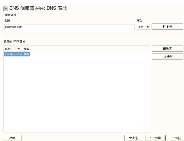
圖形 22.2 DNS 伺服器安裝：DNS 區域
