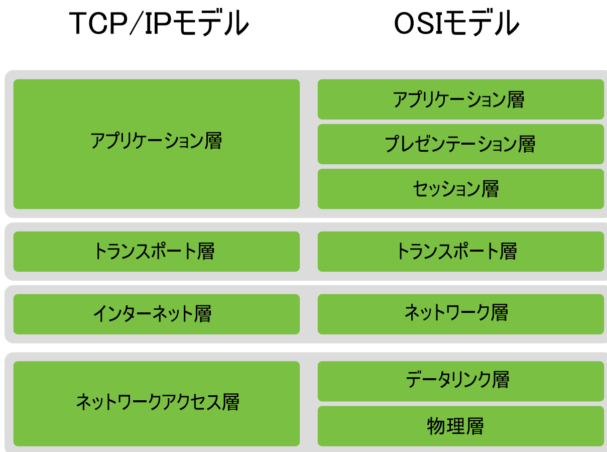
図 20.1 TCP/IPの簡易階層モデル
