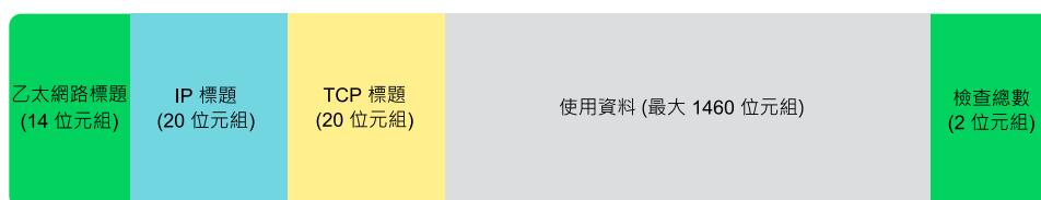
圖形 16.2 TCP/IP 乙太網路封包
