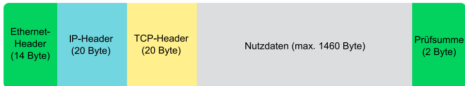
ABBILDUNG 16.2 TCP/IP-ETHERNET-PAKET
