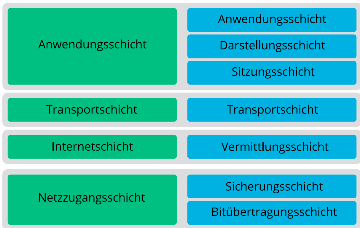
ABBILDUNG 16.1 VEREINFACHTES SCHICHTMODELL FÜR TCP/IP
