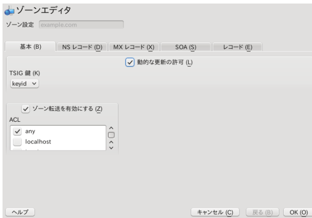
図 13.5 DNS サーバ: ゾーンエディタ (基本)
